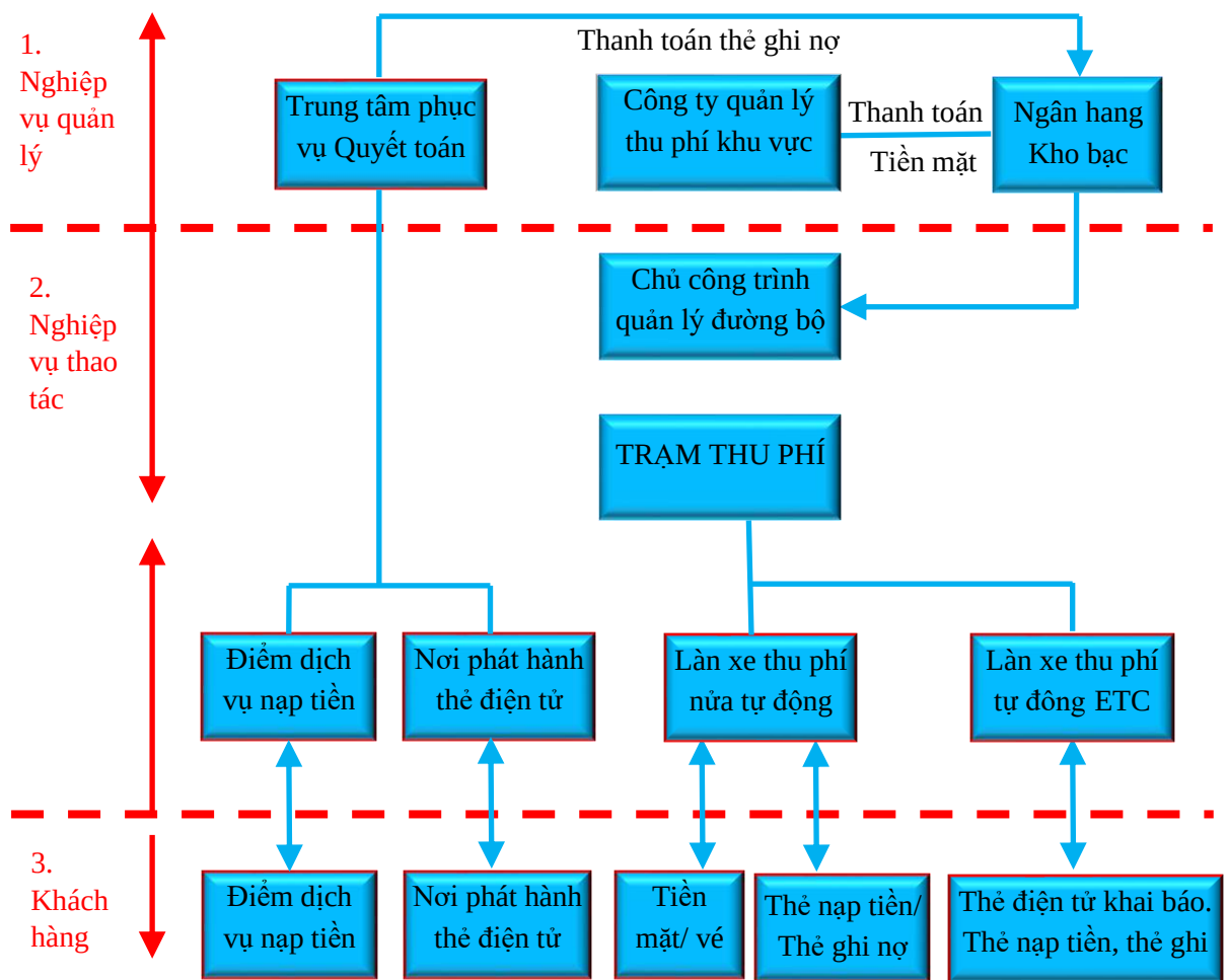
Hình 2.3 Sơ đồ cơ cấu nghiệp vụ của hệ thống thu phí điện tử không dừng xe
